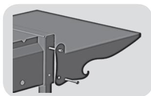
Установите ножки-стойки (*noz.2*) внутрь боковины топki (*noz.1*) с противоположной стороны. Полку боковую (*noz.3*) расположите так, чтобы ребра с отверстиями находились снаружи боковины топki (*noz.1*). Соедините полку боковую (*noz.3*), топку (*noz.1*) и ножки-стойки (*noz.2*) между собой с помощью винтов М6х40 (*noz.6*) и гаек М6 (*noz.7*).
