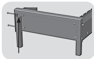
Установите ножки-стойки (*noz.2*) с внутренней стороны боковины топki (*noz.1*) до совпадения отверстий под крепежные винты.
