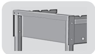
Установите раму опорную (*noz.3*) внутрь боковины топки (*noz.1*) до совпадения отверстий.
