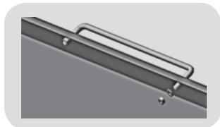
Установите ручку (*noz.6*) на крышке (*noz.5*), закрепив ее гайками М6 (*noz.15*) с внутренней стороны через шайбы М6 (*noz.16*).
