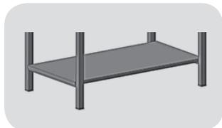
Установите полку нижнюю (*noz.8*) на перемычки рам опорных (*noz.2*) и (*noz.3*) нажатием сверху, до упора. Убедившись в отсутствии перекосов произведите окончательную обтяжку метизов с помощью гаечных ключей.
