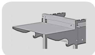
Полку боковую (*noz.4*) расположите так, чтобы ребра с отверстиями находились снаружи боковины топки (*noz.1*). Соедините полку боковую (*noz.4*), топку (*noz.1*) и раму опорную с колесами (*noz.3*) между собой с помощью винтов М6х40 (*noz.12*) и гаек М6 (*noz.15*).
