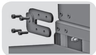
Установите крышку (*noz.5*) на боковины топки (*noz.1*), совместив отверстия на боковых поверхностях крышки с отверстиями на боковинах топки. Закрепите рычаги подъема крышки (*noz.7*) на боковинах топки (*noz.1*) и боковых поверхностях крышки (*noz.5*) с помощью винтов М5х10 (*noz.11*).
