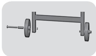
Колеса (*noz.9*), с предварительно вставленными колесными втулками (*noz.10*), закрепите на раме опорной (*noz.3*) при помощи болтов (*noz.11*) и гаек (*noz.14*).
